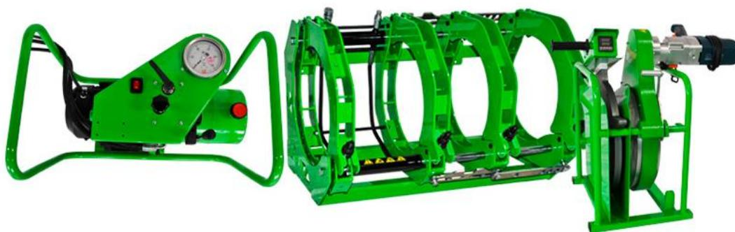
**Центратор четырехзахжимный** - предназначен для центрирования и выравнивания торцов труб и соединительных деталей. Состоит из стальной рамы, пары подвижных хомутов, приводимых в движение гидравлическими цилиндрами и пары неподвижных хомутов. Диаметр свариваемых труб от 63 мм до 225 мм
